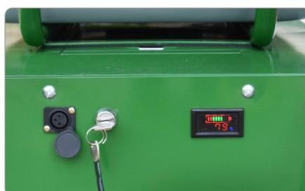
Armature de commande claire avec clé, prise de charge et écran LED avec affichage du niveau de charge
