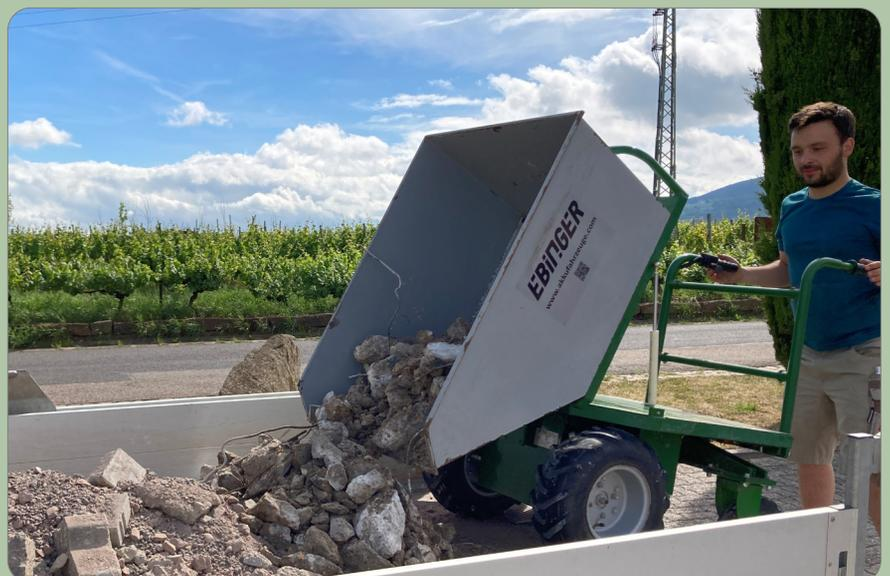
La construction à 4 roues de la Donkey Plus offre une grande stabilité et permet de monter facilement sur 2 rampes de chargement. Grâce à la construction basse, il n'est pas nécessaire de trop soulever le produit en vrac lors du chargement, ce qui facilite le travail. Le puissant moteur à engrenages se déplace en avant et en arrière.
