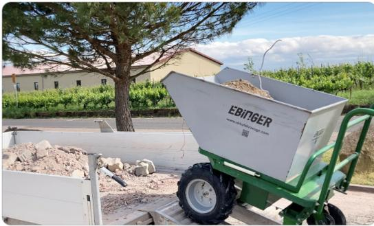
Le frein magnétique maintient toujours la brouette électrique en sécurité, même en pente
