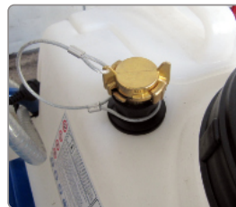
Einfüllstutzen zum sauberen Befüllen
