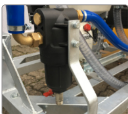
Druckfilter mit Schnellreinigung
