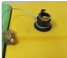
Einfüllstutzen zum sauberen Befüllen
