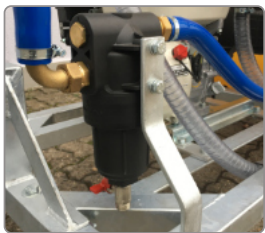
Druckfilter mit Schnellreinigung und leicht zu reinigender Saugfilter
